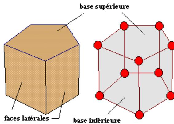
Un *prisme* est un solide constitué par deux polygones identiques appelés bases et parallèles complété par des parallélogrammes, des rectangles ou des carrés joignant les arêtes des bases. Ces derniers sont les faces latérales.
